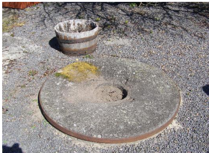
Skabelon til at lægge jernring rundt om hjulet. Bliver afkølet med vand fra spanden.
